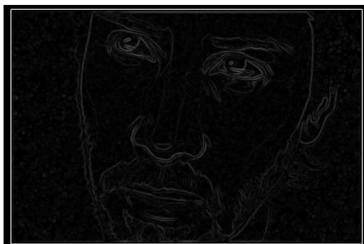
(d) Filter params: Size 12x12, \sigma = 1.5
